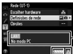
**Nível da bateria:** um visor de cinco níveis exibindo o estado de carga da bateria na UT-1.
