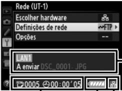
**Área de status:** o status da conexão com o computador host. O nome do computador host é exibido em verde quando a conexão for estabelecida. Enquanto os arquivos forem transferidos, o indicador de status mostra "A enviar" seguido pelo nome do arquivo sendo transferido. Quaisquer erros ocorridos durante a transferência também são exibidos aqui (📧 116).
